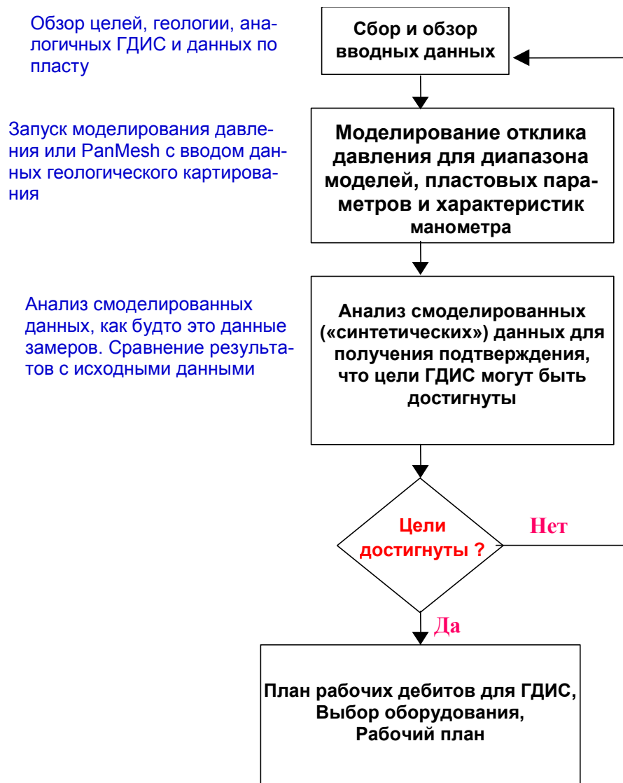
Рисунок 2: Технологический процесс проектирования ГДИС
