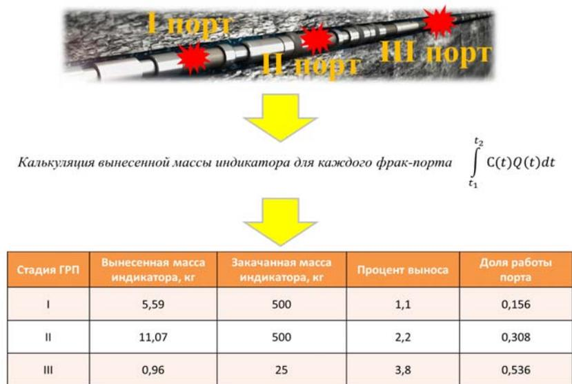
Рис. 7. Типовая схема расчета доли работы фрак-порта для каждой фазы
