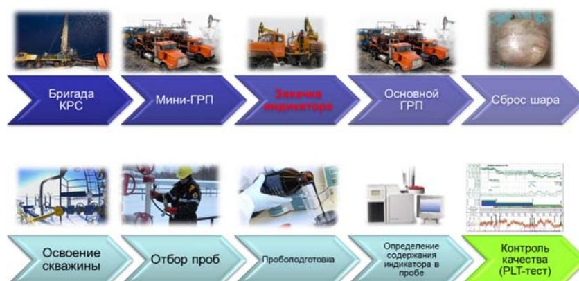
Рис. 2. Технология проведения работ по закачке индикаторного вещества при МГРП
