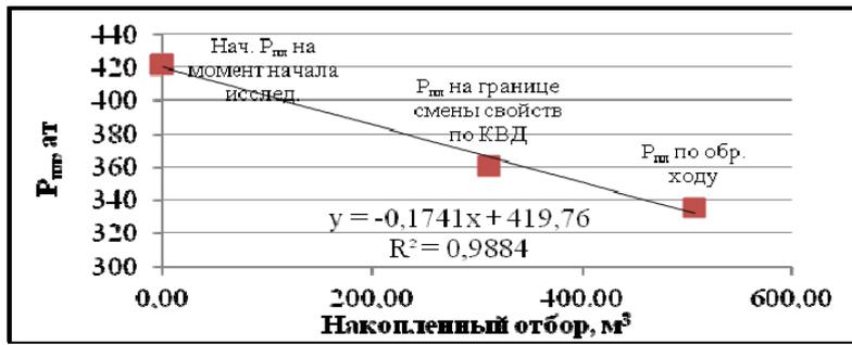
Рис. 3. Зависимость пластового давления на границе смены свойств от накопленной добычи
